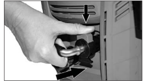
Figure 8 - Attachez le tuyau d'arrosage à l'unité
